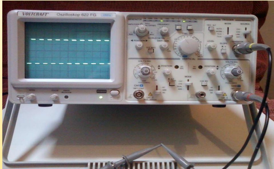
Аналогни осцилоскоп двоканални (садржи катодну цев)
